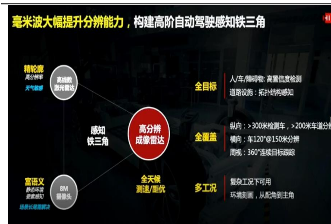
图13：毫米波雷达与摄像头、激光雷达形成优势互补
