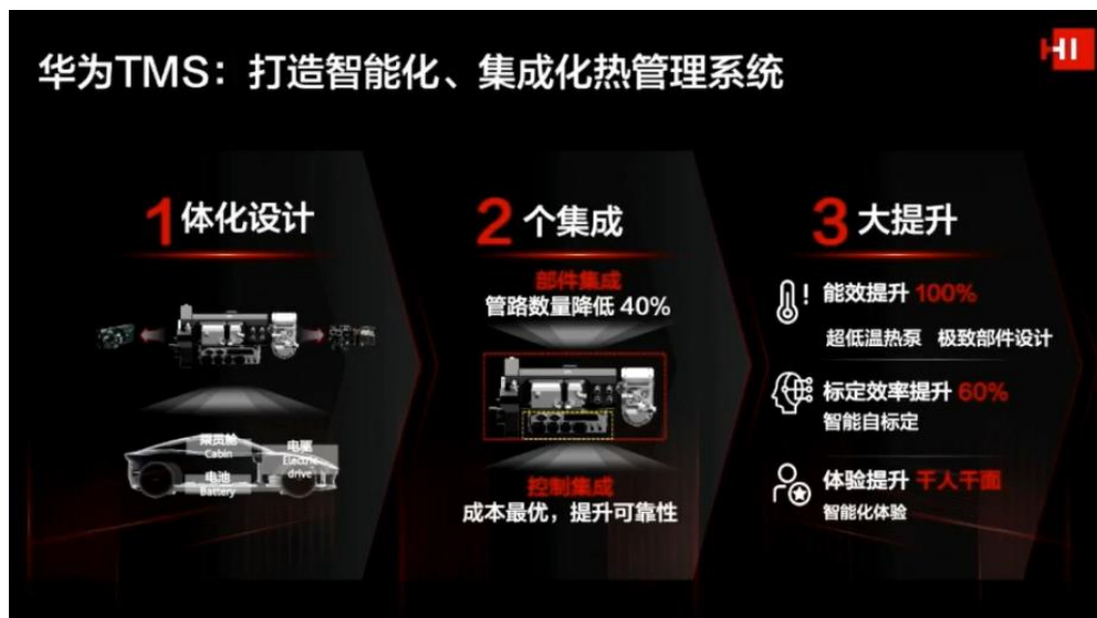
图19：集成化的 TMS 热管理系统节能效果更优
