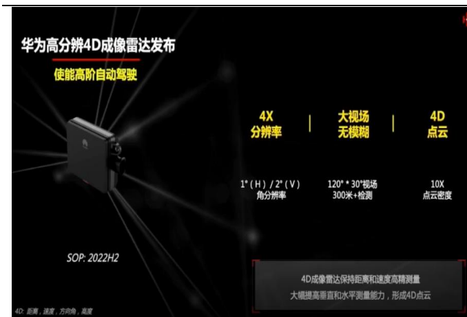
图14：华为 4D 成像雷达检测距离可达 300 米
