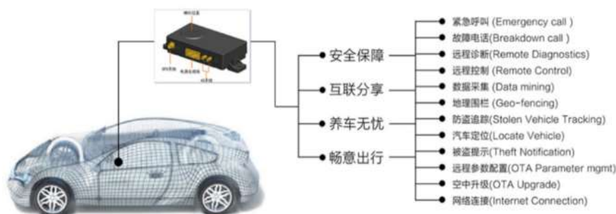
图 675: 路畅科技车联网 T-BOX 功能示意图
